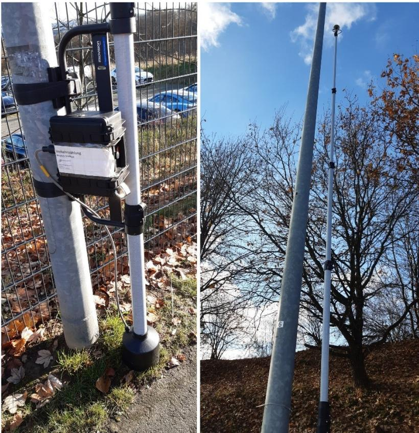
Abbildung 7: Erhebungsequipment für die 24-Stunden-Videoerfassung
