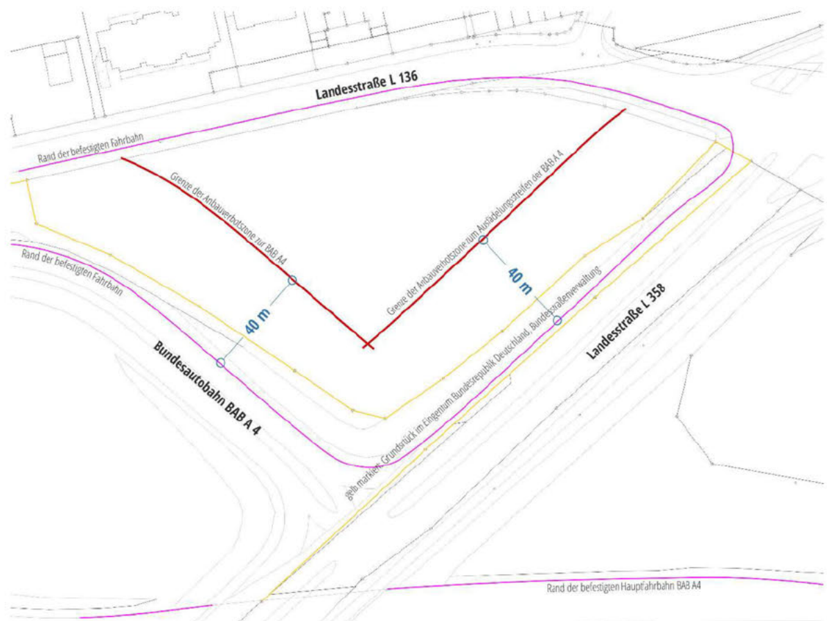
Abb. 12 Anbauverbotszonen nach § 9 FStrG im Bereich des Planungsgebietes
