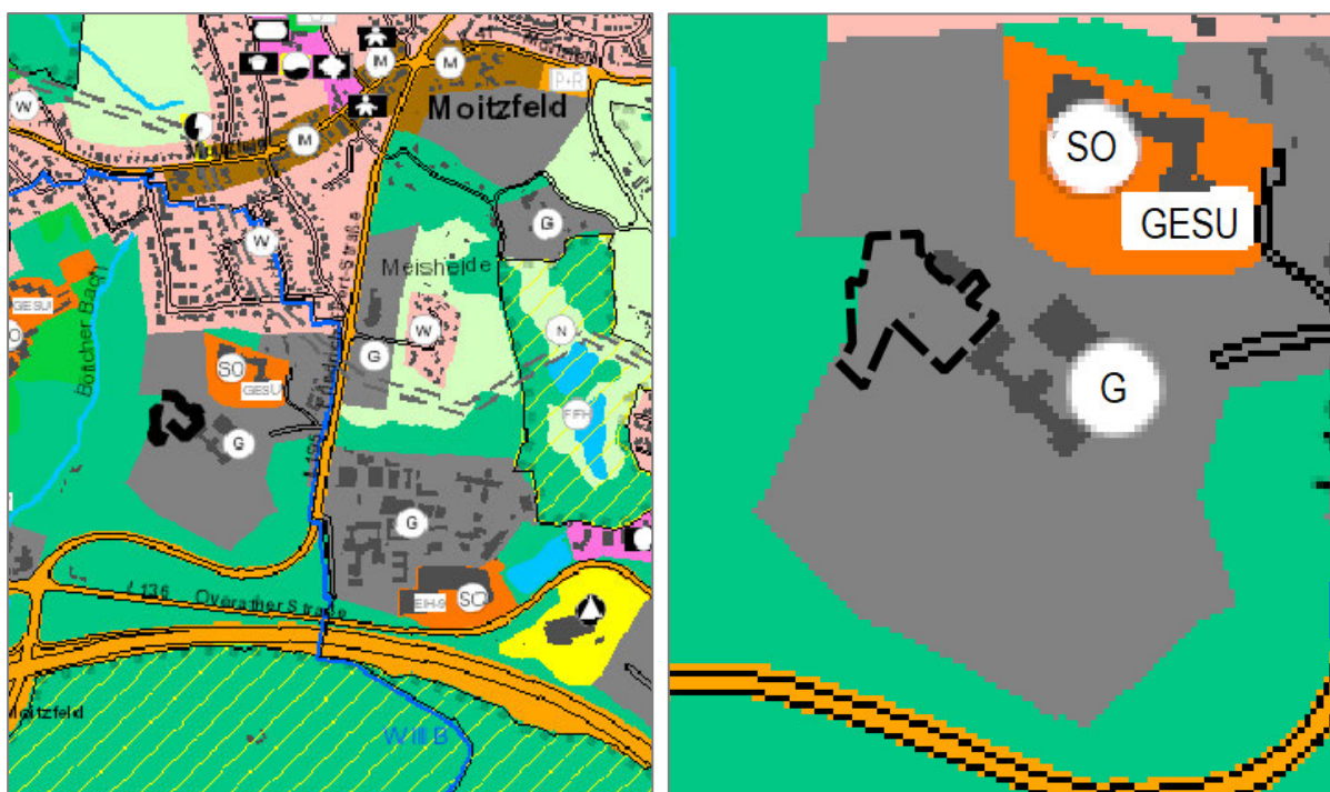
Abb. 6: Auszug aus dem Flächennutzungsplan mit Geltungsbereich des Bebauungsplans Nr. 5584. Schwarz umrandete Fläche: Geltungsbereich, graue Fläche: gewerbliche Bauflächen, angrenzende grüne Fläche: Waldflächen [Stadt Bergisch Gladbach, 2019].
