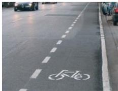
**Schutzstreifen** mit unterbrochener Linie markierte Fläche auf der Fahrbahn. Darf von Kraftfahrzeugen nur bei Bedarf befahren werden, wenn keine Gefährdung für Radfahrer besteht. Breite mindestens 1,25m.
