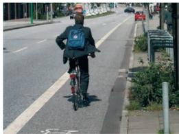
**Radfahrstreifen** mit durchgezogener Linie markierte Fläche auf der Fahrbahn. Darf von Kraftfahrzeugen nur beim Ein- / Abbiegen oder Ein- / Ausparken überquert werden.
