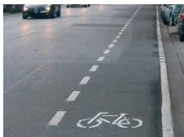
**Schutzstreifen** mit unterbrochener Linie markierte Fläche auf der Fahrbahn. Darf von Kraftfahrzeugen nur bei Bedarf befahren werden, wenn keine Gefährdung für Radfahrer besteht.
