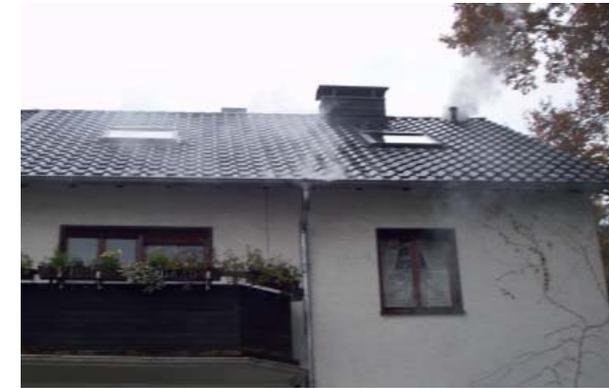
untersuchungen, Farbtests und Untersuchungen durch Kanal-TV-Kameras. Tritt z.B. beim Befüllen eines Schmutzwasserkanals der eingefärbte Nebel aus einem Regenfallrohr aus, ist der Nachweis für eine Fehleinleitung erbracht. Ebenso ist der Nachweis erbracht, wenn im Haus eingefärbtes Abwasser (Toilette, Spüle, etc.) im Regenwasserkanal abgeleitet wird.
